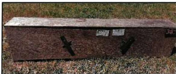
*Tunnel à empreintes et capteur poils*
